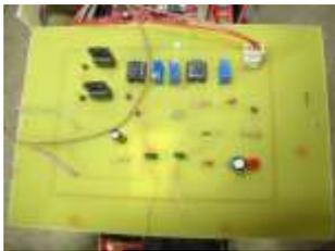
圖 1 金屬探測電路板
