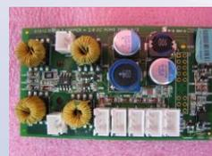
隔離型溫度偵測之線路，包含：一個溫度偵測裝置，例如：熱敏電阻前後各一個隔離電路，例如：變壓器
