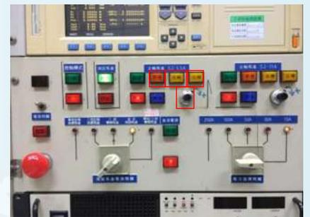
接著就可以開始旋轉旋鈕調整轉速，調整到所要測量的轉速後，就可以開始量測反電動勢波形，實際測量情形如右圖。
