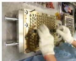
(E)對角用螺絲平均撐起後將 Pin 盤移除。
