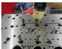
(G)模具背後放置砂膠墊，避免Block掉落桌面受損將Block背後螺絲鬆開，栓入較長的螺絲，使用膠槌對角方式輪流輕敲螺絲退出Block。
