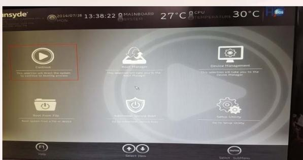
此圖為 Insyde BIOS 的 SCU 控制介面，像是系統的大腦一般的存在，負責掌管許多項目的設定，例如：密碼、日期、時間與進入 OS 模式都由這裡控制，在這裡的測試主要是確認 BIOS 本版與 SCU 設定的相關功能測試，並測試是否能正常回復成預設值、儲存或切換個人設定值。
