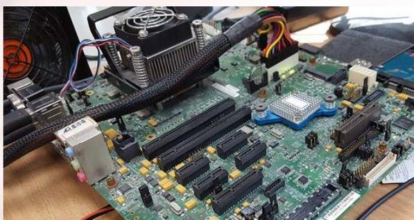
此圖為測試機台:Broadwell platform，主要是我測試 kernel5.1 R1.5和 R2的測試工板，將測試 BIOS 燒入測試機台上，開關機是否正常，並可進入 SCU 開始測試。
