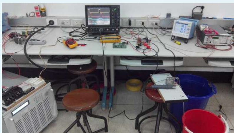
圖 3 加熱器搭配驅動電路板測試
