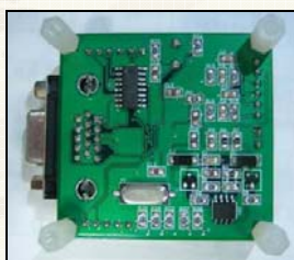
圖二、四層解析電路板背面
