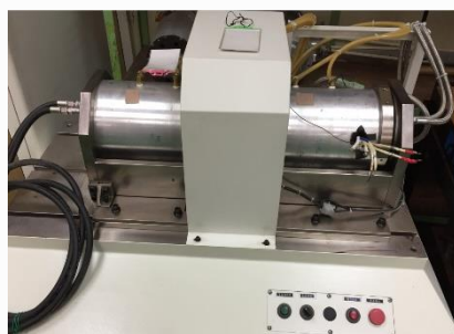
圖二、耦合之同款式永磁馬達動態負載測試系統
