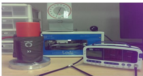
圖四. 血壓波形模擬器與血壓計連接
