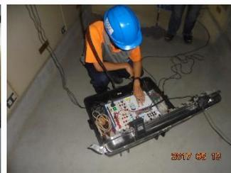
圖(七)保護電驛測試
