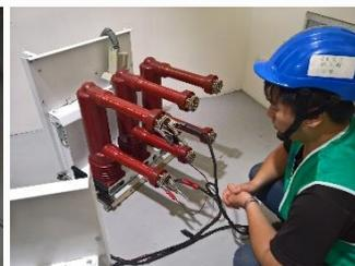
圖(八)低電阻測試
