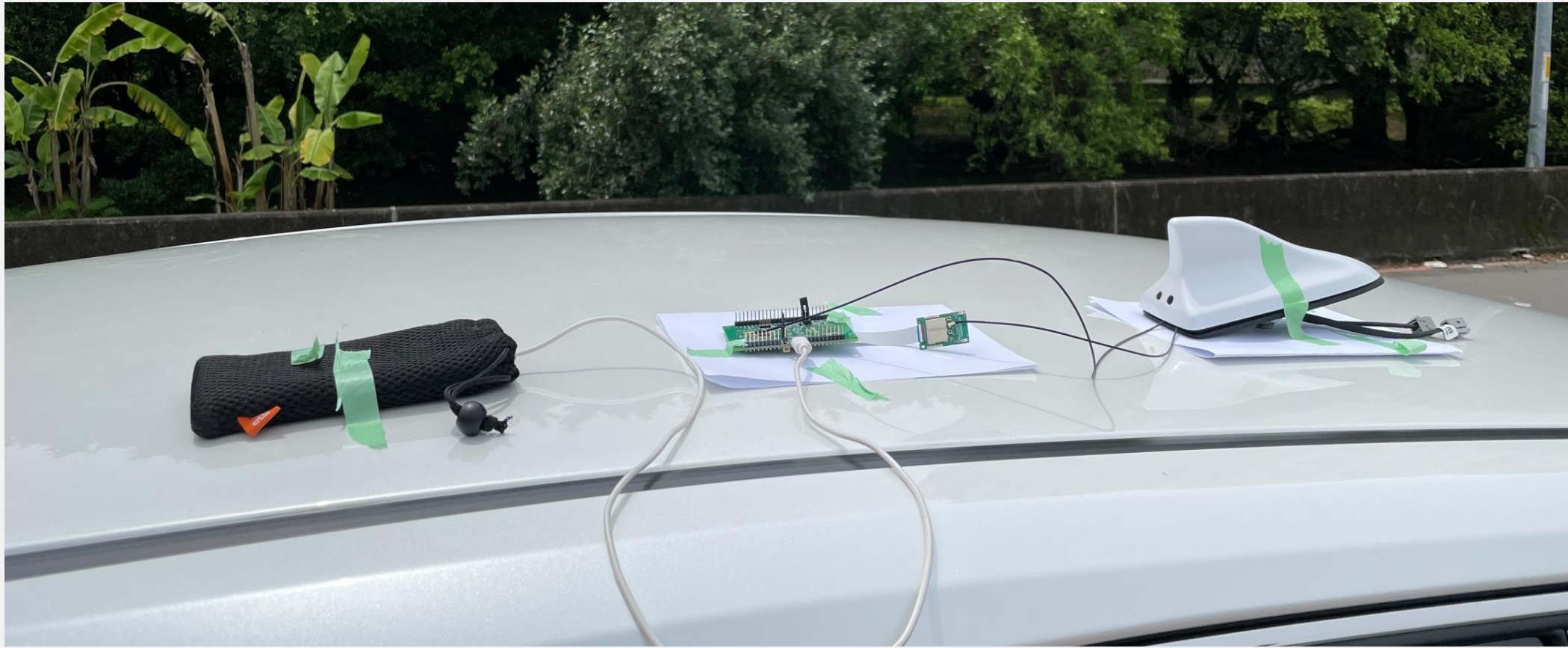
圖4 UWB模組與天線實際結合架構
