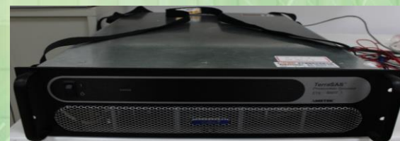
5 kW 太陽能電池模擬系統
